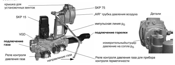
Выполнить соединение воздушной линии управления (синяя трубка) от штуцера "AIR" на компактном блоке к штуцеру измерения давления воздуха на газовой обойме. Трубка синего цвета является линией управления для компактного газового блока и должна пролегать в свободном изгибе, без перегибов.
