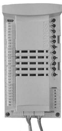
MPA 22 - топочный автомат с микропроцессорным управлением для контроля и управления пневмо-модулирующей вентиляторной горелкой с одним сервоприводом. Для работы с интегрированным прибором контроля герметичности клапанов. Топочный автомат MPA 22 может быть подключен к шине передачи данных e-BUS.
