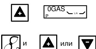
После установки параметров для **P1**, нажмите клавишу "Плюс" для настройки **P0** (стартовая точка). На дисплее высвечивается **0 Gas**.
