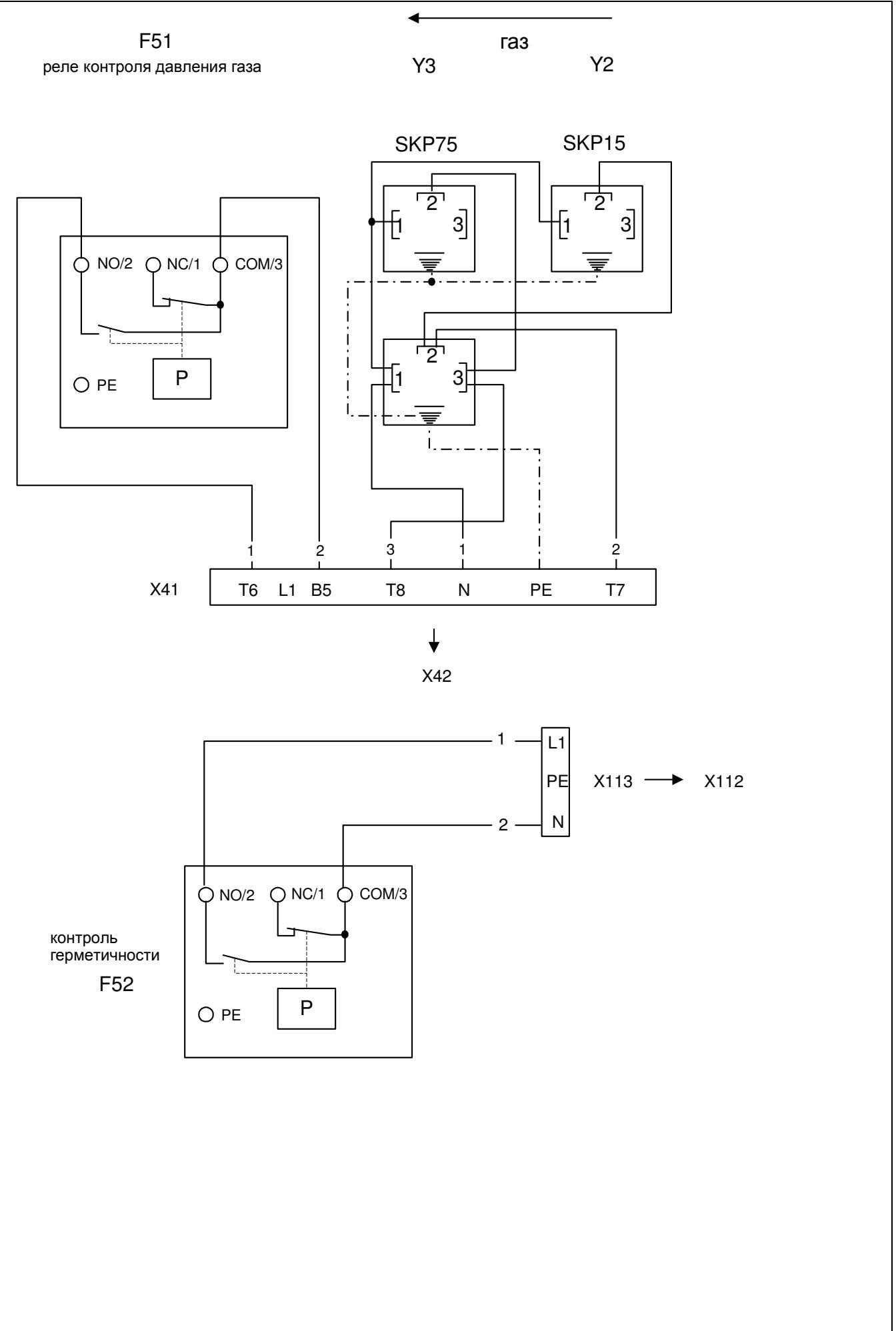
Электрическая схема стр. 4b (газовая рампа CG)
