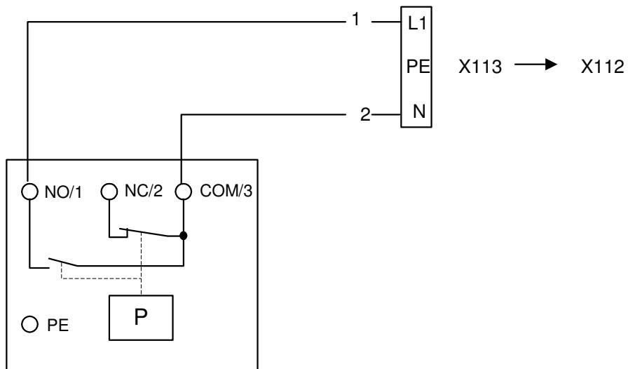
ПОДКЛЮЧЕНИЕ ЭЛЕКТРОДВИГАТЕЛЯ ВЕНТИЛЯТОРА
