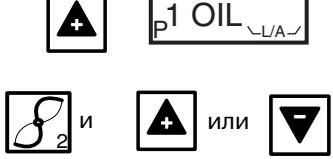
После установки параметров для **2-й ступени**, нажмите на кнопку "Плюс", чтобы настроить **1-ю ступень**. На дисплее высвечивается 1OIL.
