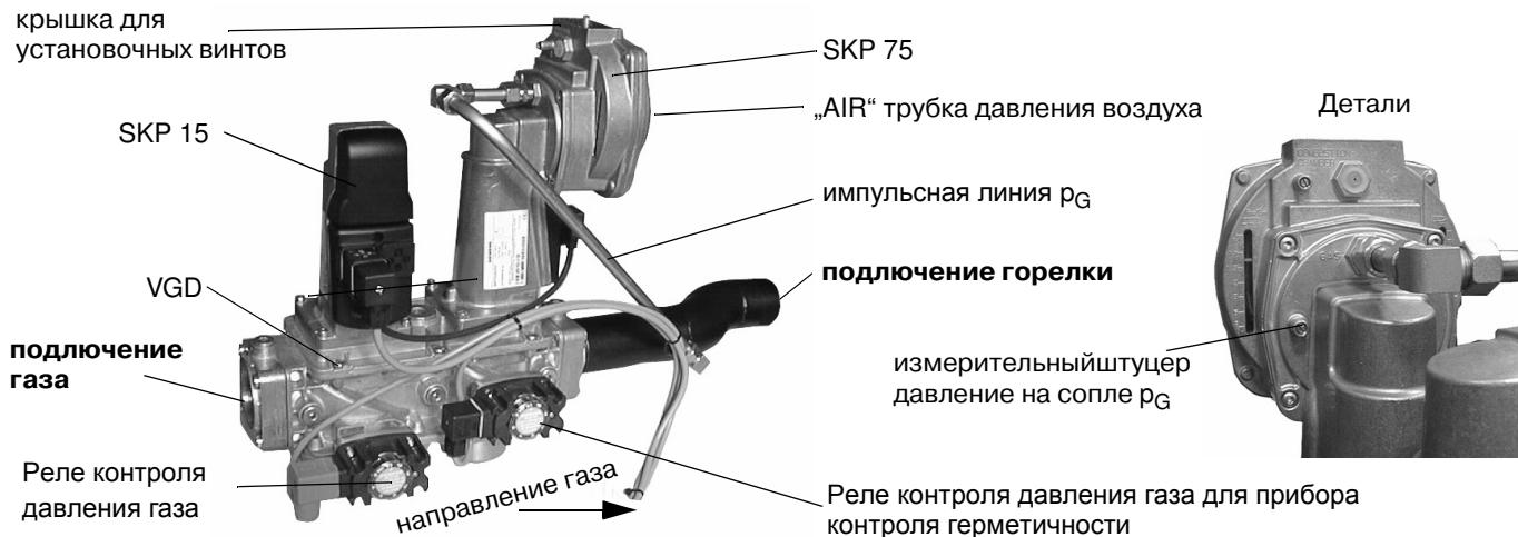
Выполнить соединение воздушной линии управления (синяя трубка) от штуцера „AIR“ на компактном блоке к штуцеру измерения давления воздуха на газовой обойме. Трубка синего цвета является линией управления для компактного газового блока и должна пролегать в свободном изгибе, без перегибов.
