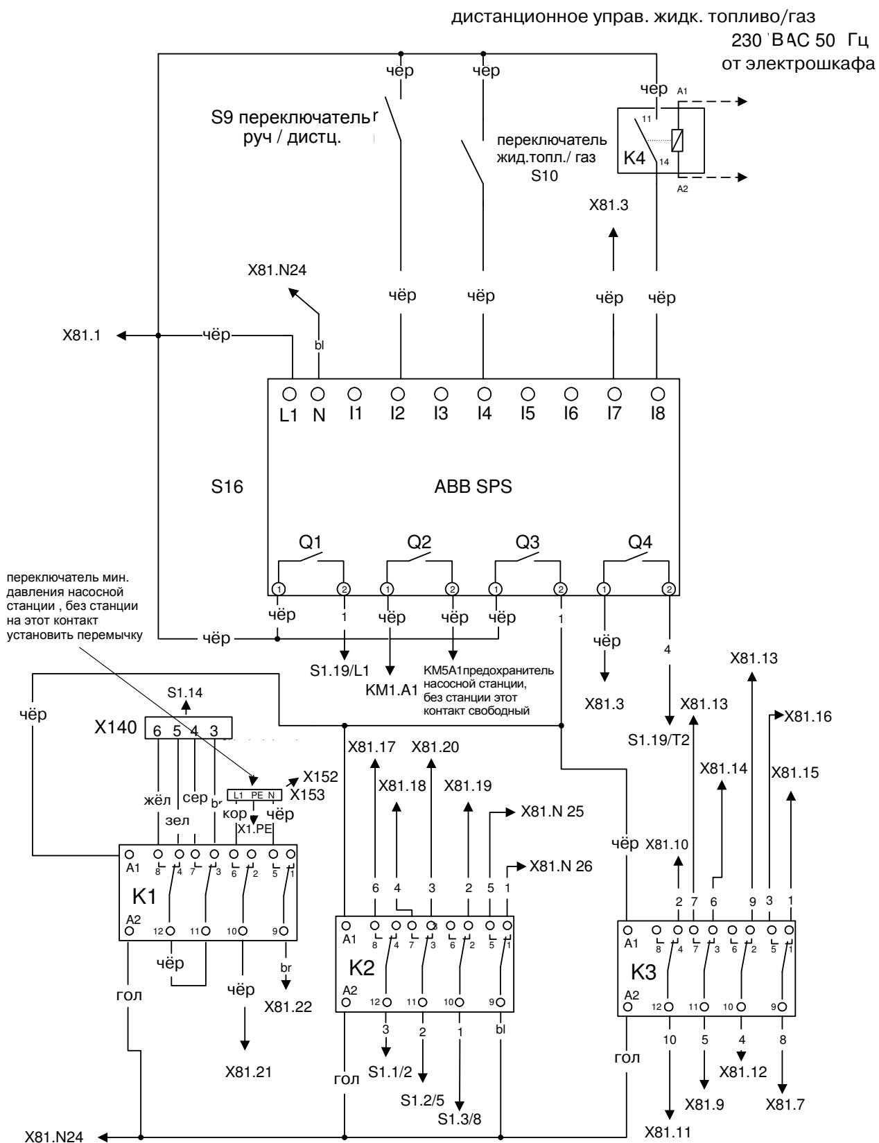
Электрическая схема стр. 4а (газовая рампа SKP)
