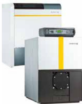
Достоинством вышеупомянутого оборудования можно смело назвать секционную конструкцию теплообменника. Именно она позволяет посекционно доставлять разобранный теплообменник на место установки, то есть на крышу в котельную, и там уже на месте собирать готовый теплообменник котла. Небольшой вес одной секции по сравнению с собранным многосекционным теплообменником упрощает и удешевляет транспортировку котла на крышу.
