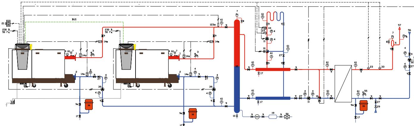
**Схема 2. Котельная установка с 2 котлами С 330 в каскаде**
