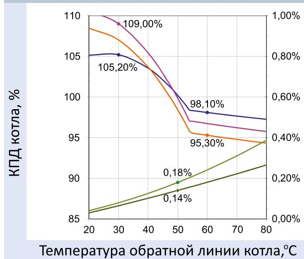
Коэффициент полезного действия конденсационного котла существенно изменяется в зависимости от его мощности и температурного режима работы.
