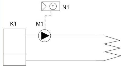
Циркуляционный насос теплого пола
