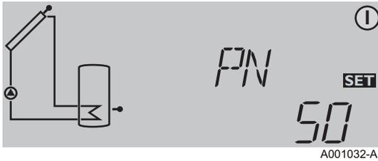
. Параметр настройки PN позволяет задать минимальное значение на выходе реле R1 для режима насоса контура солнечной установки. Чем меньше значение режима насоса, тем меньше его расход.
