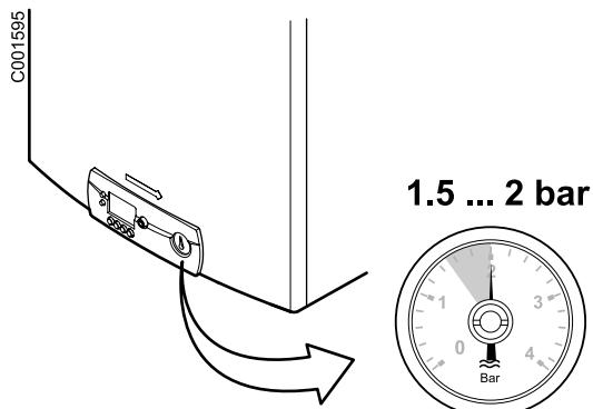
1. Проверить давление воды в установке.
