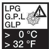
В установках сниженного газа не эксплуатировать VPS 508 при температуре ниже 0 °C. Подходит только для газообразного сжиженного газа, жидкое углеводорода нарушают уплотнительные материалы.
