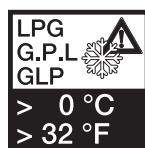
В газожидкостных системах не эксплуатировать VDK 200 A ниже 0 °C. Подходит только для газообразного сжиженного газа, жидкое углеводорода нарушают уплотнительные материалы.
