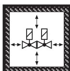
Не допускается прямой контакт между VPS 504 и кирпичными, бетонными стенами, полом.
