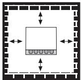
Direkter Kontakt zwischen VPM und aus-härtendem Mauerwerk, Betonwänden, Fußböden ist nicht zulässig.
