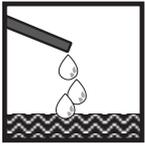
Конденсат не должен попадать в прибор. При минусовых температурах возможны сбои/выходы из строя вследствие обледенения.
