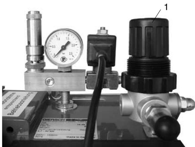
Первичный воздух устанавливается в зависимости от необходимой мощности регулятором давления воздуха (1). Необходимые данные можно определить по ниже приведённой диаграмме. Топливо с большей вязкостью требует более высокое давление воздуха.
