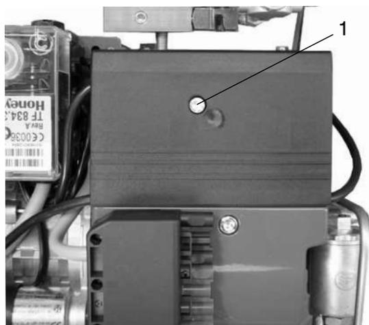
С помощью потайного ключа (NW4) открутить винт 1 и снять крышку
