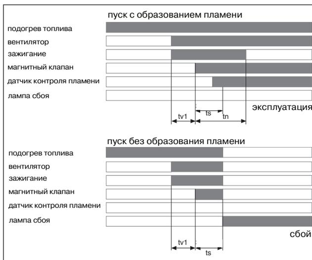
$t_s$  - контрольно-предохранительный период
