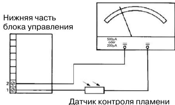
Для измерения фототока снимается штекерная часть датчика контроля пламени и между штекером и разъёмом подключается измерительный прибор. При отрицательном отклонении стрелки измерительного прибора следует поменять полярность измерительного кабеля. Прибор применяется для измерения постоянного тока, диапазон измерений примерно до 200 мА.
