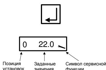
Для того чтобы открыть сервисную функцию необходимо удерживать нажатой примерно 2 сек. кнопку «Подтвердить». На дисплее высветиться точка **P0** и заданные значения воздушной заслонки сервопривода при розжиге в градусах и символ «отвёртки», обозначающий сервисную функцию.
